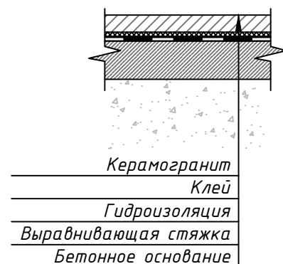
Узел устройства гидроизоляции
